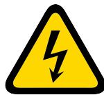
"Advertencia; electricidad" y se utiliza para advertir personas sobre el riesgo de entrar contacto con la electricidad (por ejemplo, descarga eléctrica, peligro de electrocución, voltaje peligroso).
