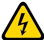
„Warnung; Strom“ und dient der Warnung Menschen über das Risiko, herein zu kommen Kontakt mit Elektrizität (z. B. Stromschlag, Stromschlaggefahr, gefährliche Spannung).
