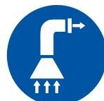
„Während des Betriebs müssen Absaugventilatoren verwendet werdenMaschinen
