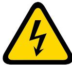
"Avertissement; électricité » et il est utilisé pour avertir les gens sur le risque d'entrer dans contact avec l'électricité (par exemple choc électrique, risque d'électrocution, tension dangereuse)
