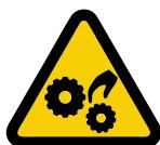
« Risque d'écrasement » et il est utilisé pour avertir les gens prendre soin d'éviter d'entrer en contact avec pièces mobiles pendant le fonctionnement.
