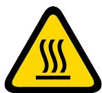
« Surface chaude » et il est utilisé pour avertir les gens de veiller à éviter tout contact avec une surface chaude .
