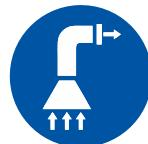
« Des ventilateurs d'extraction doivent être utilisés pendant le fonctionnement de machinerie .
